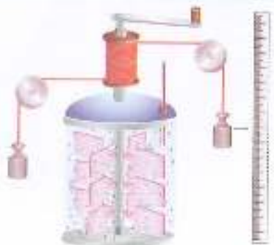
▲ Experimento de Joule para medir la variación de la temperatura.
