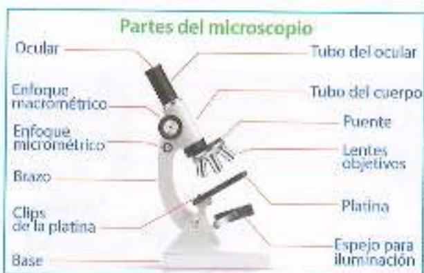
▲ Microscopio óptico, con el que normalmente se alcanzan a ver objetos de 0,2 nanómetros.
