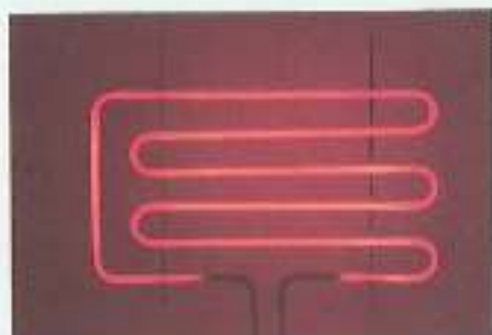
▲ Una de las aplicaciones de la transformación de energía eléctrica en calor es la calefacción eléctrica por medio de una resistencia de nichrome.
