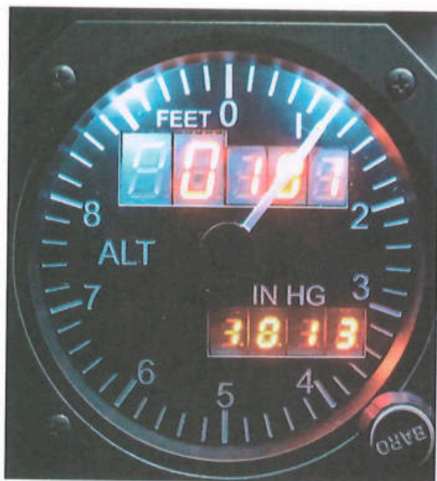
▲ Fotografía hecha en la cabina de un avión de un altímetro que, es a la vez, analógico y digital. La fiabilidad de este aparato es clave para poder volar.
