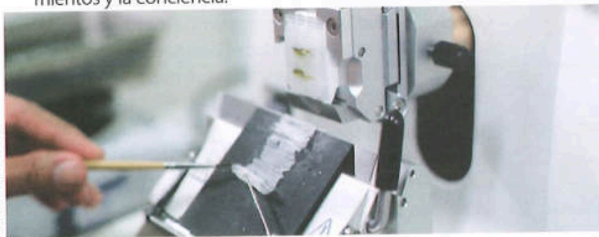
▲ Micrótopo, instrumento necesario en histología para realizar cortes con grosores de apenas pocas micras.
