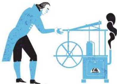
▲ Máquina de vapor funcionando. Se reconocen las siguientes partes: 1) horno o caldera con un gran recipiente con agua; 2) tuberías que transportan el agua en forma de gas hasta un pistón; 3) rueda que se mueve gracias a la acción del pistón (4).
