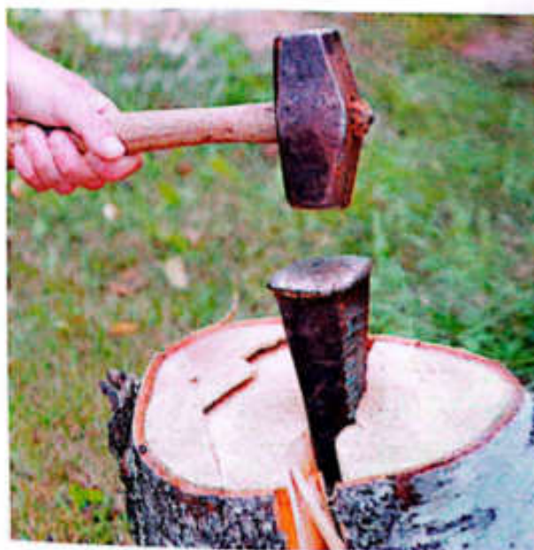
▲ Con una cuña se incrementa la fuerza para partir un tronco.
